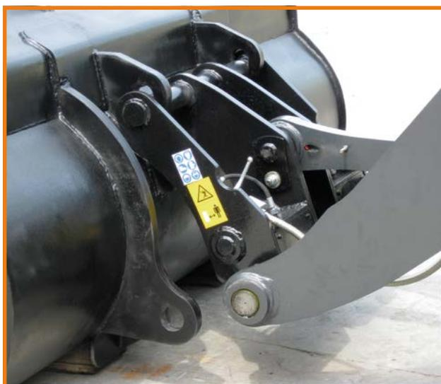
L'aggancio rapido M3 con modifica della benna originale non sposta il baricentro della macchina lasciando inalterata la capacità di carico e la forza di strappo. È particolarmente apprezzato per utilizzi particolarmente gravosi, ove sono richieste le massime prestazioni della macchina.
