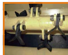
Coltelli leggeri per erba e sarmenti. Diam.max 1 cm. Rotore H
